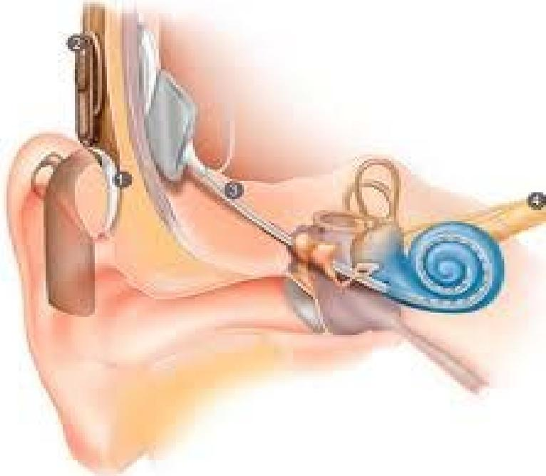
Les sons captés (1) sont transmis à un processeur (mini-ordinateur) qui les transforme en signaux électriques. Une antenne (2) transmet ces signaux électriques à la partie implantée (3), jusqu'au faisceau d'électrodes placé dans l'oreille interne (cochlée). Les impulsions électriques générées stimulent les fibres du nerf auditif (4). L'implant cochléaire permet très souvent une bonne compréhension de la
